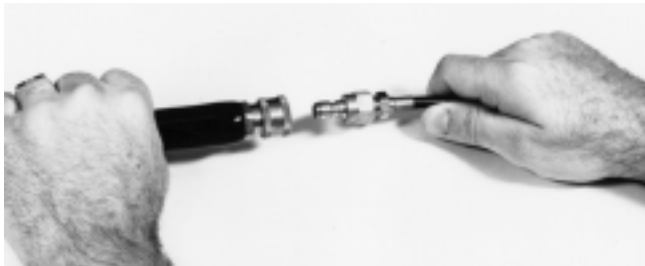
Figura 3 – Acoplamiento de la manguera a la Limpiadora
