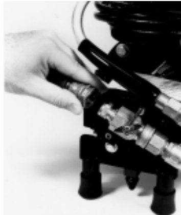
Figura 2 – Conecte la manguera de suministro de agua a la Limpiadora. Cierre la válvula de admisión del suministro (se la muestra en posición CERRADA)
