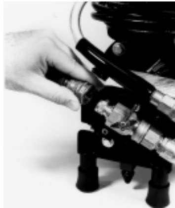
Figure 2 – Branchement du tuyau d'arrivée d'eau sur le dégorgeoir. Fermeture du robinet d'arrivée (montré en position fermée).
