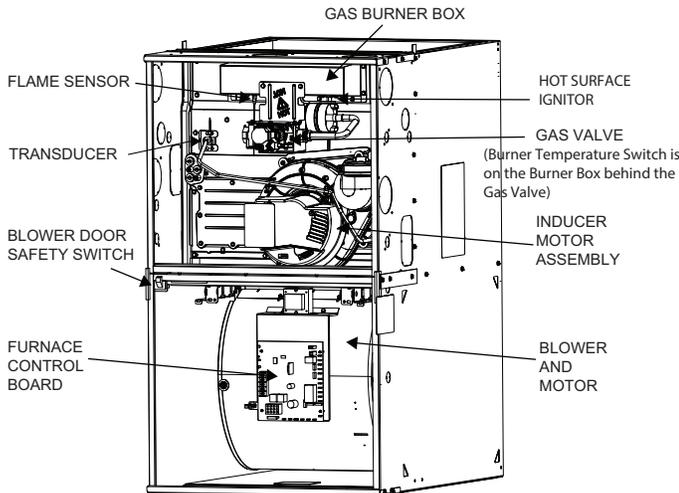
**Fig. 1 – Furnace Components**
