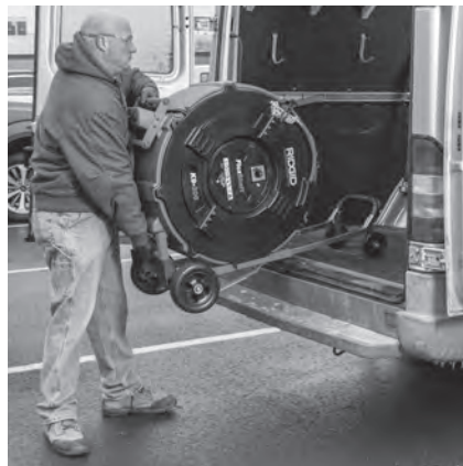
Figura 13 – Colocación de la máquina en el camión
