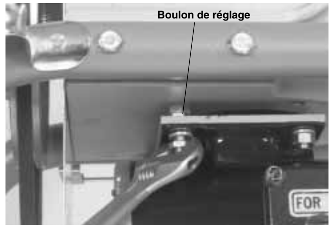
Figure 15 – Réglage de la courroie d'entraînement
