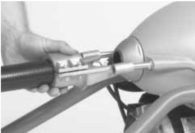
Figure 3 – Montage du guide-câble arrière
