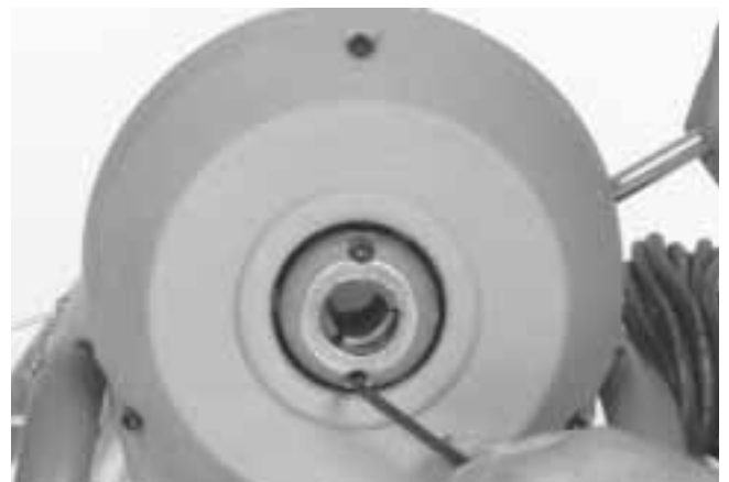
Figura 12 – Recambio de las mordazas del embrague
