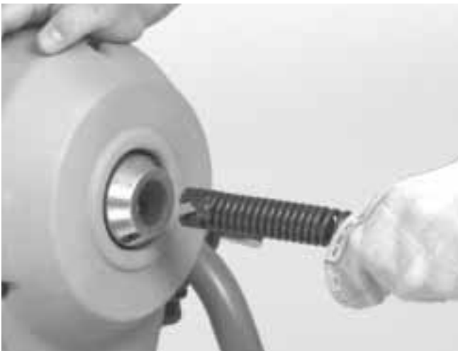
Figure 4 – Introduction du câble via l'avant de la machine
