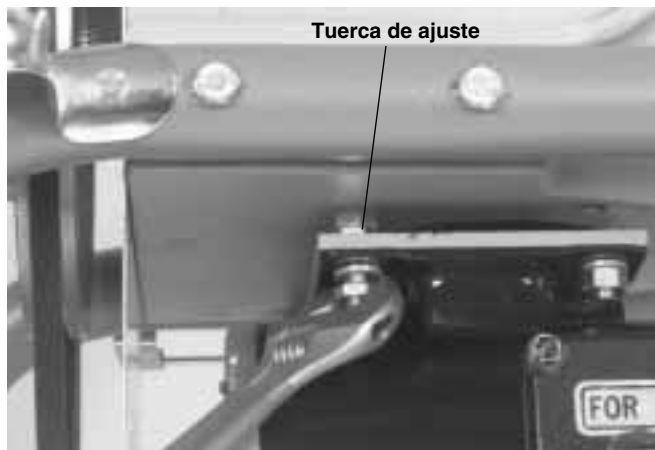
Figura 15 – Regulación de la correa trapezoidal
