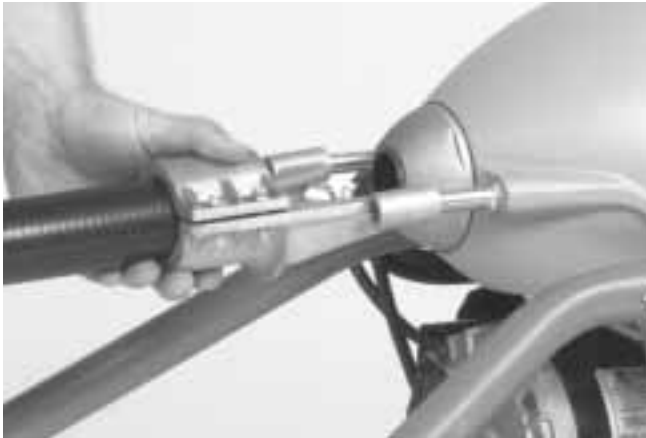
Figura 3 – Acoplamiento de la manguera guía trasera
