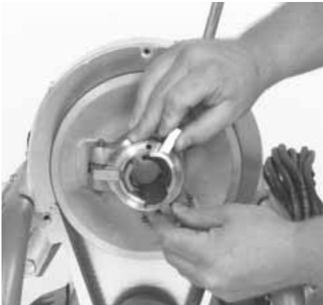
Figura 13 – Recambio de las mordazas del embrague
