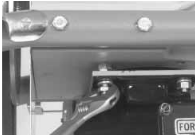
Figura 14 – Eliminación del juego (holgura) del embrague
