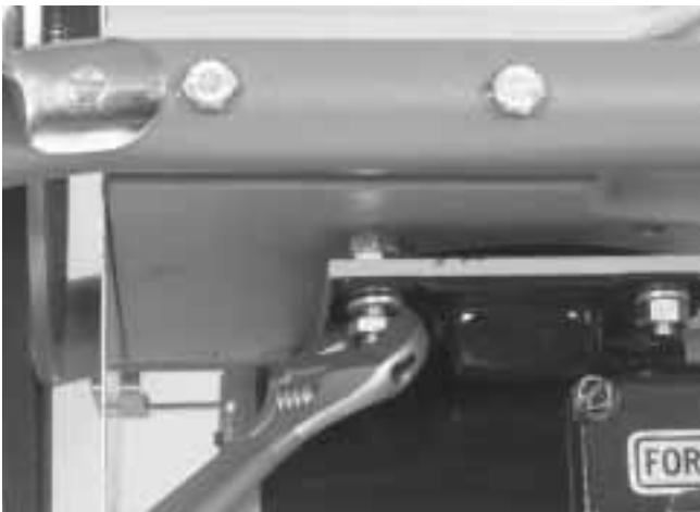
Figure 14 – Élimination du jeu de l'embrayage
