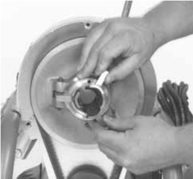
Figure 13 – Remplacement des mâchoires d'embrayage
