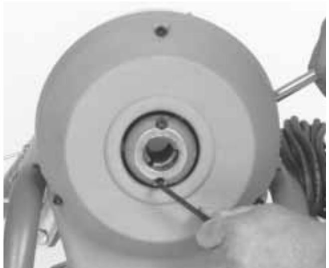
Figure 12 – Remplacement des mâchoires d'embrayage
