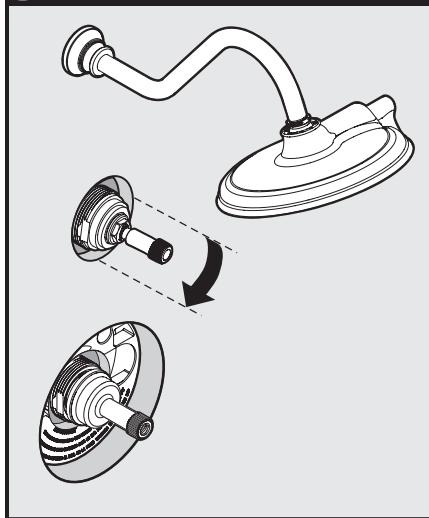
**8****Temperature Valve / Válvula de temperatura / Soupape de température**
