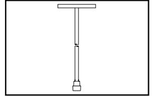
SHUT-OFF ROD FOR CURB BOX VALVE OPERATION
