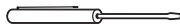
Petit tournevis à tête plate (pointe de 2 à 2,4 mm ou 3/32", 60 mm de longueur)
