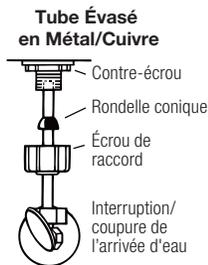
Ces pièces doivent être utilisées comme illustré pour assurer un raccordement étanche. L'utilisation d'un écrou de raccord existant peut entraîner une fuite d'eau. Le tube ou le tuyau d'arrivée d'eau doit entrer d'au moins 1/2" à l'intérieur de la tige filetée de la vanne (ne s'applique pas aux tubes à bride).
