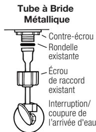
Utiliser l'écrou de raccord et la rondelle existants.
