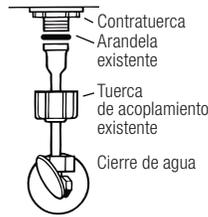
Use la arandela y tuerca de acoplamiento existente.
