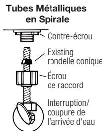
Rondelle conique existante utiliser la rondelle conique hélicoïdale existante.
