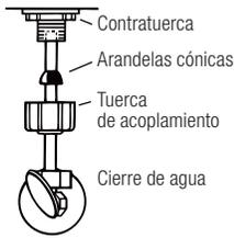
Estas piezas se deben usar según se ilustra para garantizar una conexión hermética. El uso de la tuerca de acoplamiento existente puede provocar una fuga de agua. El tubo o tubería de suministro de agua se debe extender al menos 12.7 mm dentro de la varilla roscada de la válvula (no aplica a la tubería abocardada).
