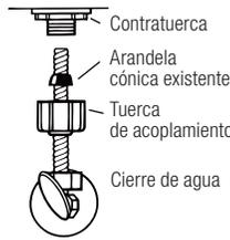
Use la arandela cónica espiral existente. Es posible que la arandela cónica maestra de fluidos no selle completamente en la línea de suministro de tipo espiral.
