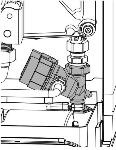
Figure 43: Bypass Valve
