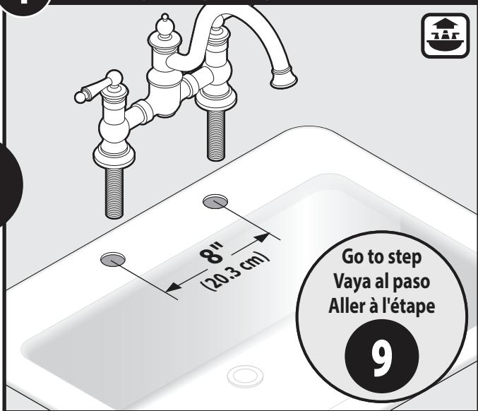
**9**Go to step number **9**.Vaya al paso número **9**.Aller à l'étape **9**.Insert Faucet Body (**B**) with attached Faucet Body Escutcheon (**L**) into sink openings.Inserte el cuerpo de la mezcladora (**B**) con el chapetón (**L**) conectado al mismo en las aberturas del fregadero.Insérer le corps du robinet (**B**), avec la rosace du corps de robinet (**L**) attachée, dans les ouvertures de l'évier.
