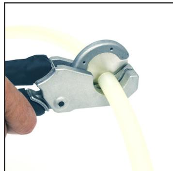
2. Faites glisser l'anneau/le manchon PEX sur le tuyau PEX jusqu'à ce qu'il atteigne la languette d'arrêt.
