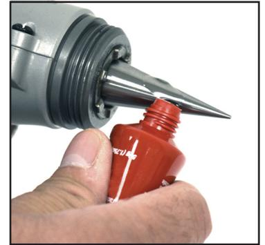
4. Introduzca el cabezal de expansión en la tubería PEX-A. Presione el activador. El cabezal de expansión se dilatará, se retraerá y rotará ligeramente en cada ciclo. Tenga en cuenta que algunos cabezales de expansión no rotarán automáticamente. Si este es el caso, presione con cuidado la tubería en el cabezal de expansión y haga una rotación de 1/8 en cada dirección.
