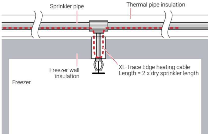
**Figure 17: XL-Trace Edge on extended pendant sprinklers**
