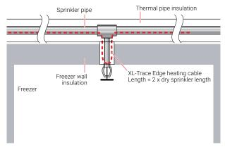
Figure 17: XL-Trace Edge on extended pendant sprinklers
