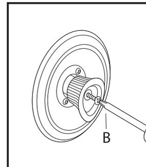
4. Avec la bague d'espacement (D) en place, réinstallez la poignée.
