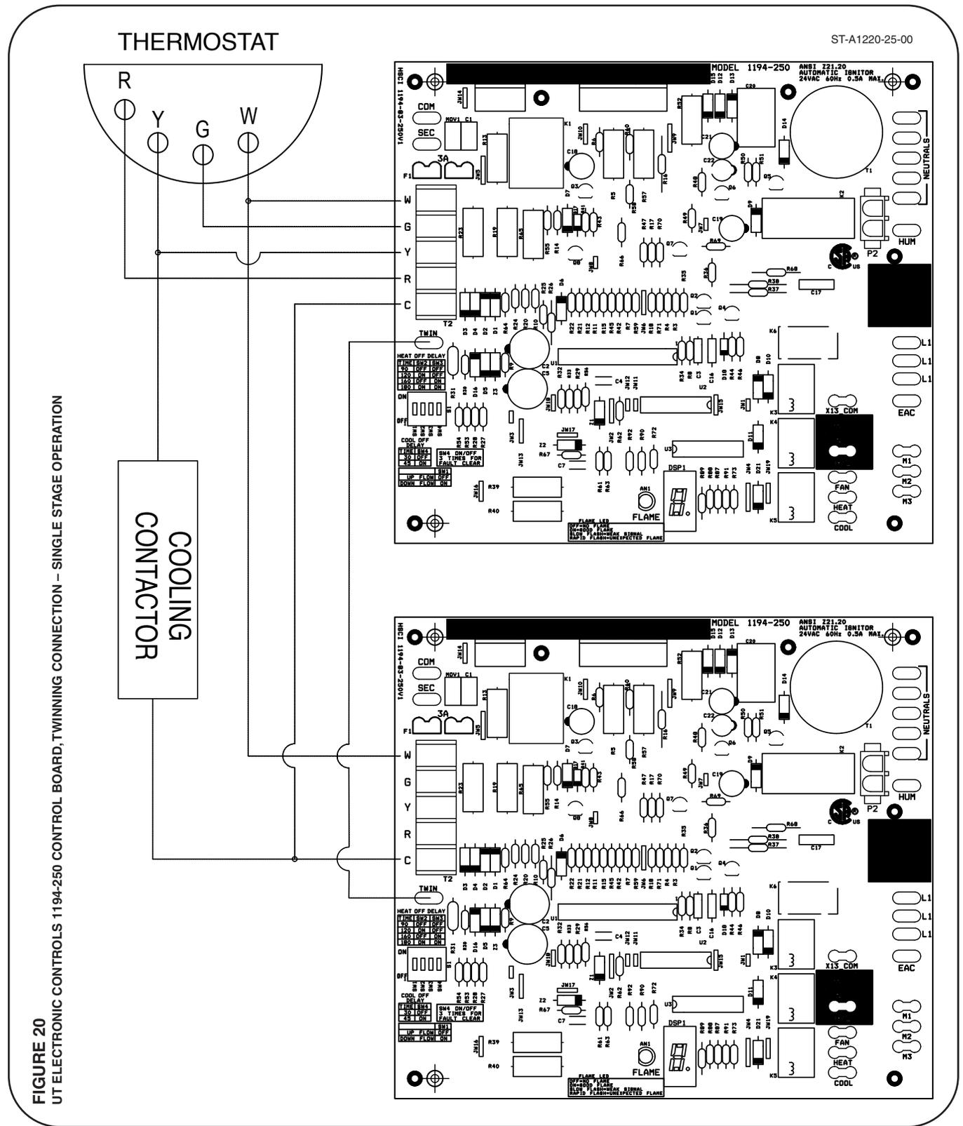
FIGURE 20 UT ELECTRONIC CONTROLS 1194-250 CONTROL BOARD, TWINNING CONNECTION - SINGLE STAGE OPERATION
