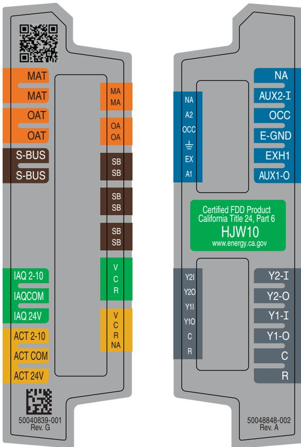
**Fig. 46 — W720 Wiring Terminals**
