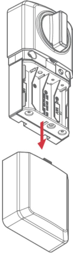
Retire la cubierta interior del ensamblaje interior.
