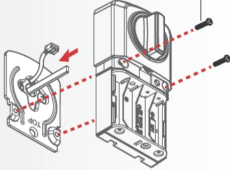
Asegure el ensamblaje interior
