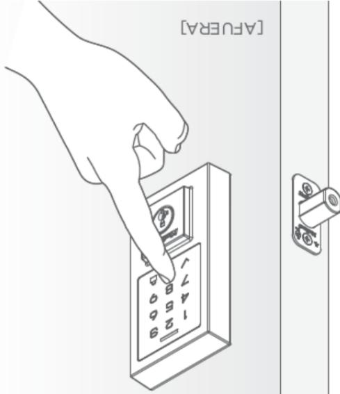
Asegure la cubierta interior en el ensamblaje interior.
